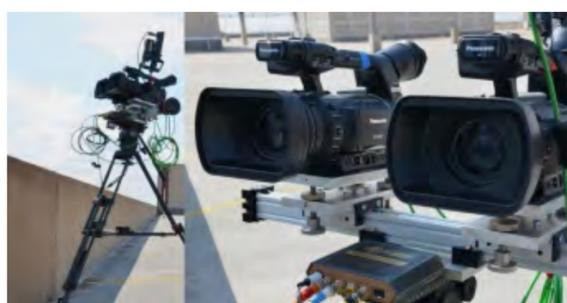
**Panasonic HPX-250:** zwei Camcorder auf einem Side-by-Side-Rig, aufgezeichnet wird in AVC-Intra 100Mbit – 10bit 422 (x2), Chipgröße: 1/3", Stereobasis variabel und vom Rig abhängig, hier IA Rig = 170mm bis 530mm.
